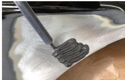
Eine geringe Menge Ausschussmaterial bei einer neuen Düse ist möglich, wenn das vorherige Material mit hohem Druck oder wenn zuvor eine große Menge Material ausgedrückt wurde.
